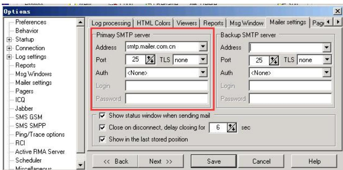
在图中红框中填写 SMTP 地址以及端口号，填写完成后，点击 save 保存即可。
