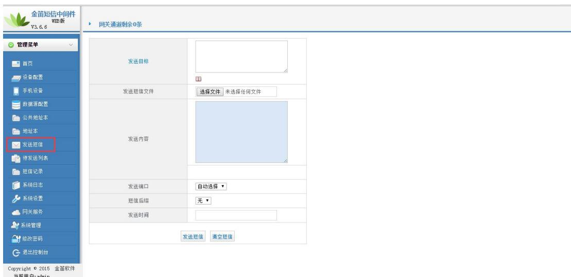
上图中可以看到发送目标手机填写框以及短信内容填写框，下方的短信内容框可以实时计算所输入的字数。发送端口可以手动/自动选择，默认为自动选择，且程序会判断哪个 COM 口空闲（只针对多口 MODEM 设备有效），如果单口 MODEM
