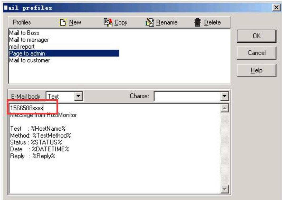
在模版中，邮件内容第一行为接收短信提醒的手机号码，如果多个号码可以用“；”分隔。编辑完成后保存即可。
