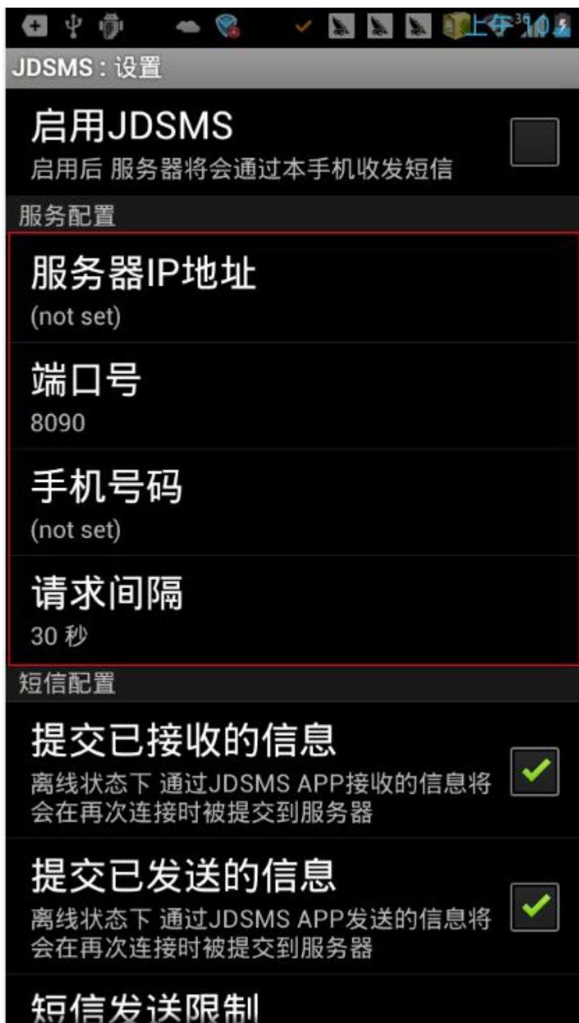
服务器 IP 地址：此处请填写所安装 WEB 中间件服务器的 IP 地址。（填写之前，请先确保手机所连 WIFI 与 WEB 中间件服务器可以 PING 通。）
