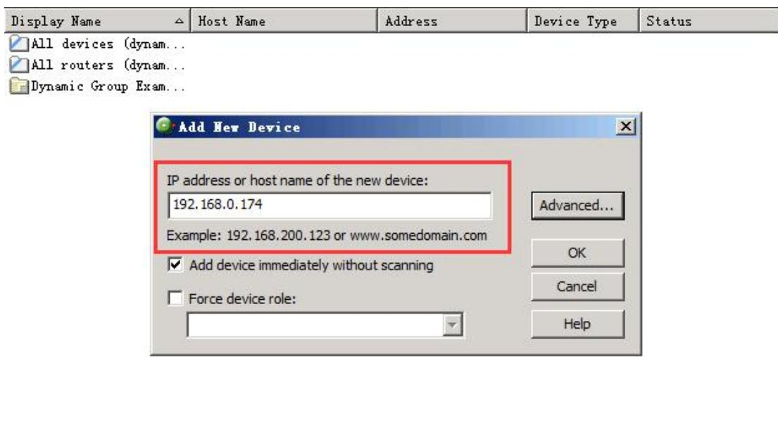
在上图红框处填写被监控对象的 ip 地址以及设备名称，填写完成后，点击 OK 按钮后，会弹窗显示该对象的详细配置，下一步要配置报警动作，如下图所示：
